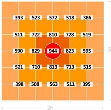
0.6x0.6m 植物帐篷，高度 0.31m 上一代产品 平均 PPFd: 604 \mu\text{mol}/\text{m}^2/\text{s} 均匀度 U1: 42%
